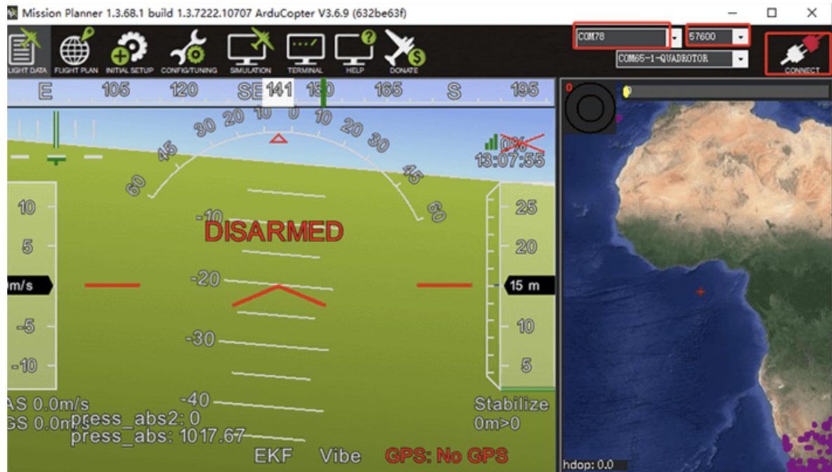
图 2.2 MP 地面站连接示意图
